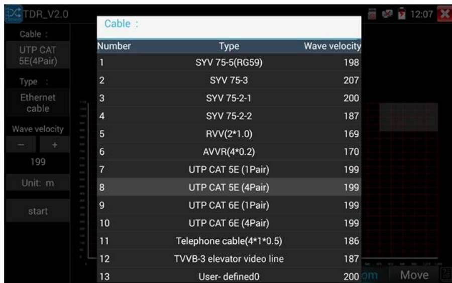
Рис. 123 Калибровка типа кабеля для TDR тестирования
