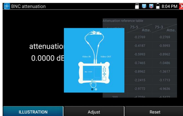
Рис. 125 Подключение кабеля для определения степени затухания
